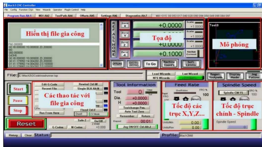
Hình 26. Giao diện trang màn hình khi dùng Mach3 điều khiển máy phay CNC 4 trục
