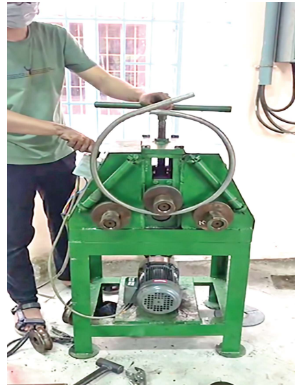
Hình 3.2 Vận hành khảo nghiệm
