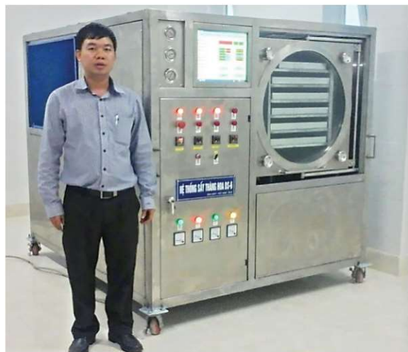
Hình 9. Máy sấy thăng hoa và sản phẩm của công nghệ sấy thăng hoa (đồng trùng hạ thảo, trái cây cao cấp ...)
