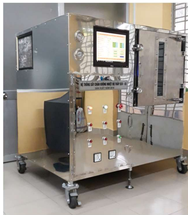
Hình 5. Máy sấy chân không DSV – ĐHSPKT Tp.HCM
