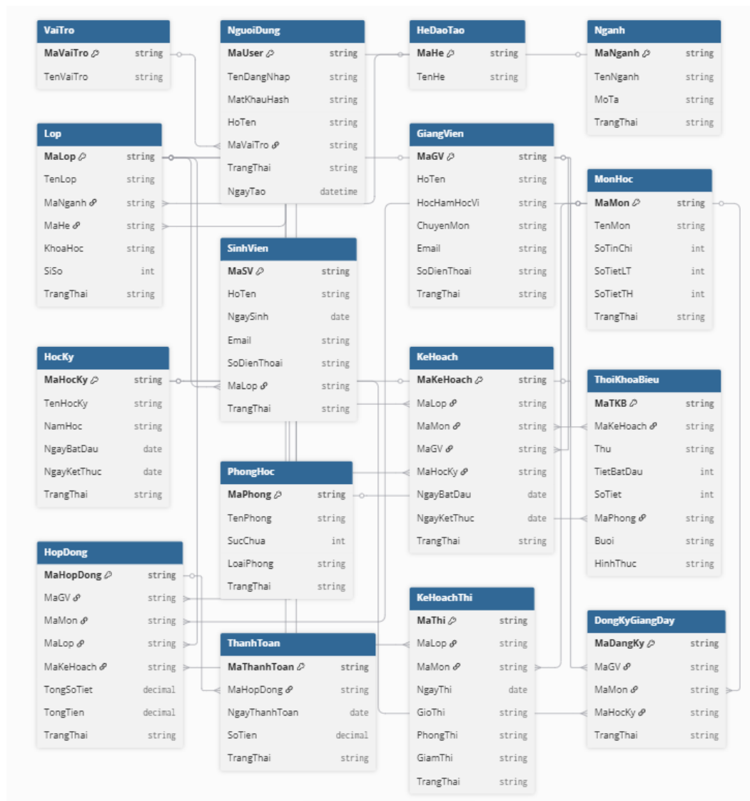
Hình 3. Sơ đồ thực thể – quan hệ (ERD) tổng thể của hệ thống quản lý đào tạo
