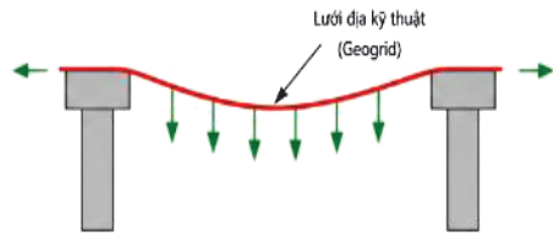
Lưới địa kỹ thuật biến dạng võng xuống giữa các đầu cọc và sinh lực kéo (tension), phân phối lại tải trọng và hạn chế lún cục bộ.
